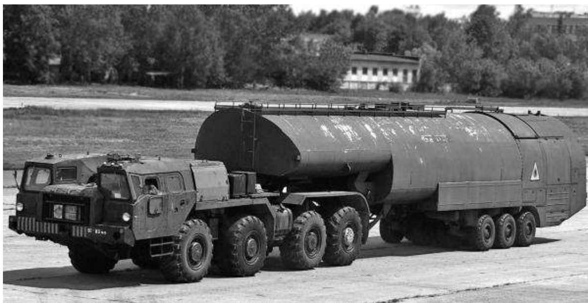
Усиленный седельный тягач МАЗ-74103 с полуприцепом-заправщиком ТЗ-60 (АТЗ-60-8685). 1981 год
