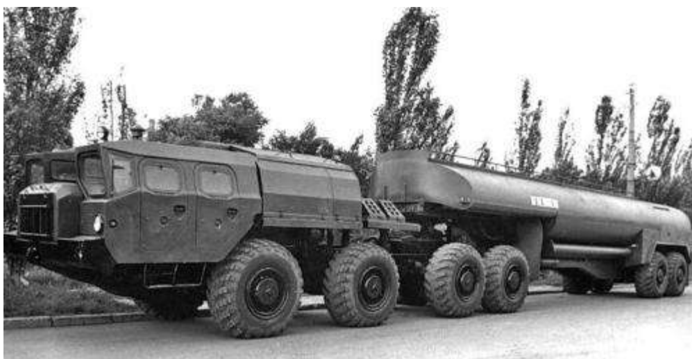
Седелный тягач МАЗ-7410 с активным полуприцепом-заправщиком АТЗ-30-9989. 1978 год
