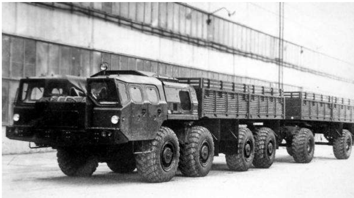
650-сильный бортовой грузовик-тягач МАЗ-7911 «Оплот-А» с прицепом МАЗ-8950. 1974 год
