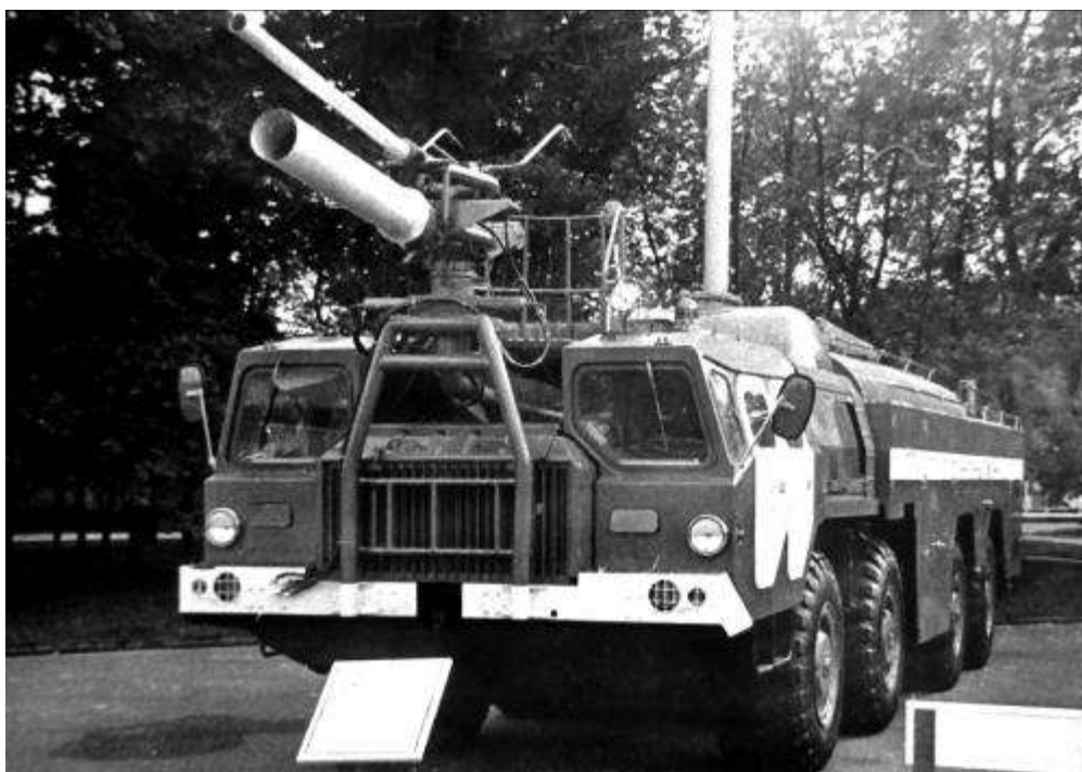
Пожарный автомобиль АА-70 (7310)-220 комбинированного тушения на шасси МАЗ-7310. 1980 год
