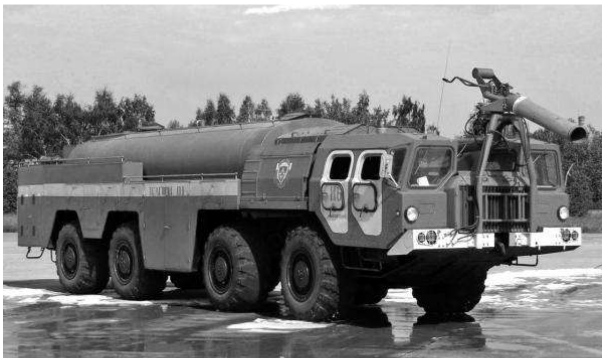
Аэродромный пожарный автомобиль АА-60 (7313)-160.01 пенного тушения на шасси МАЗ-7313
