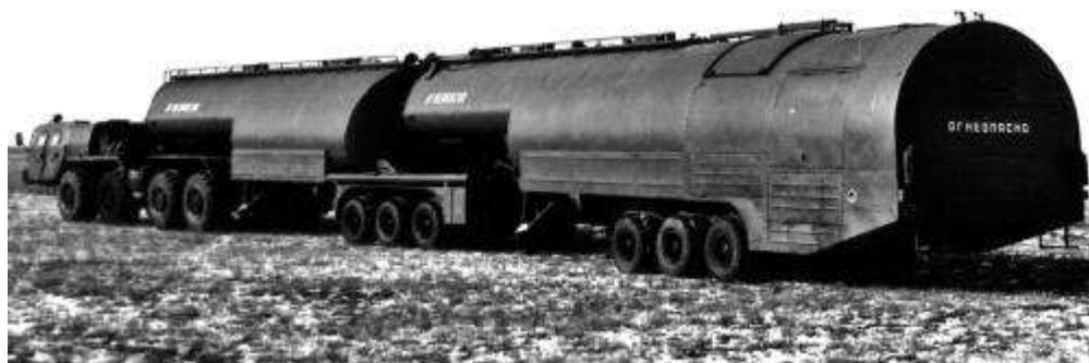
Тягач МАЗ-74103 в составе двухзвенного полуприцепного топливозаправщика ТЗ-90. 1987 год
