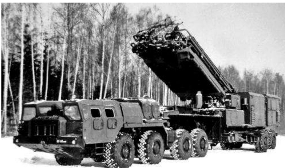
Тягач МАЗ-74106 с полуприцепом МАЗ-9988 и радиолокатором 64Н6Е зенитной системы С-300ПМ
