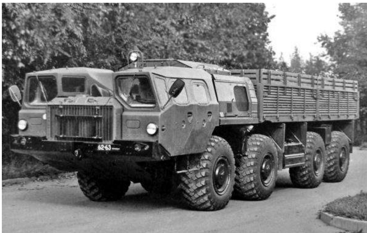
Автомобиль-тягач МАЗ-7310 двойного назначения с деревометаллическим кузовом. 1973 год
