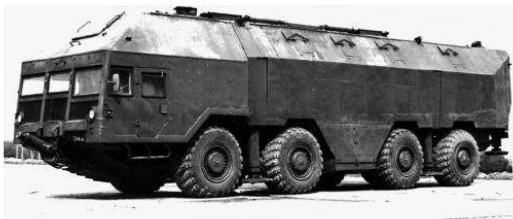
Экспериментальная самоходная береговая ракетная установка «Редут» на шасси MAZ-79111
